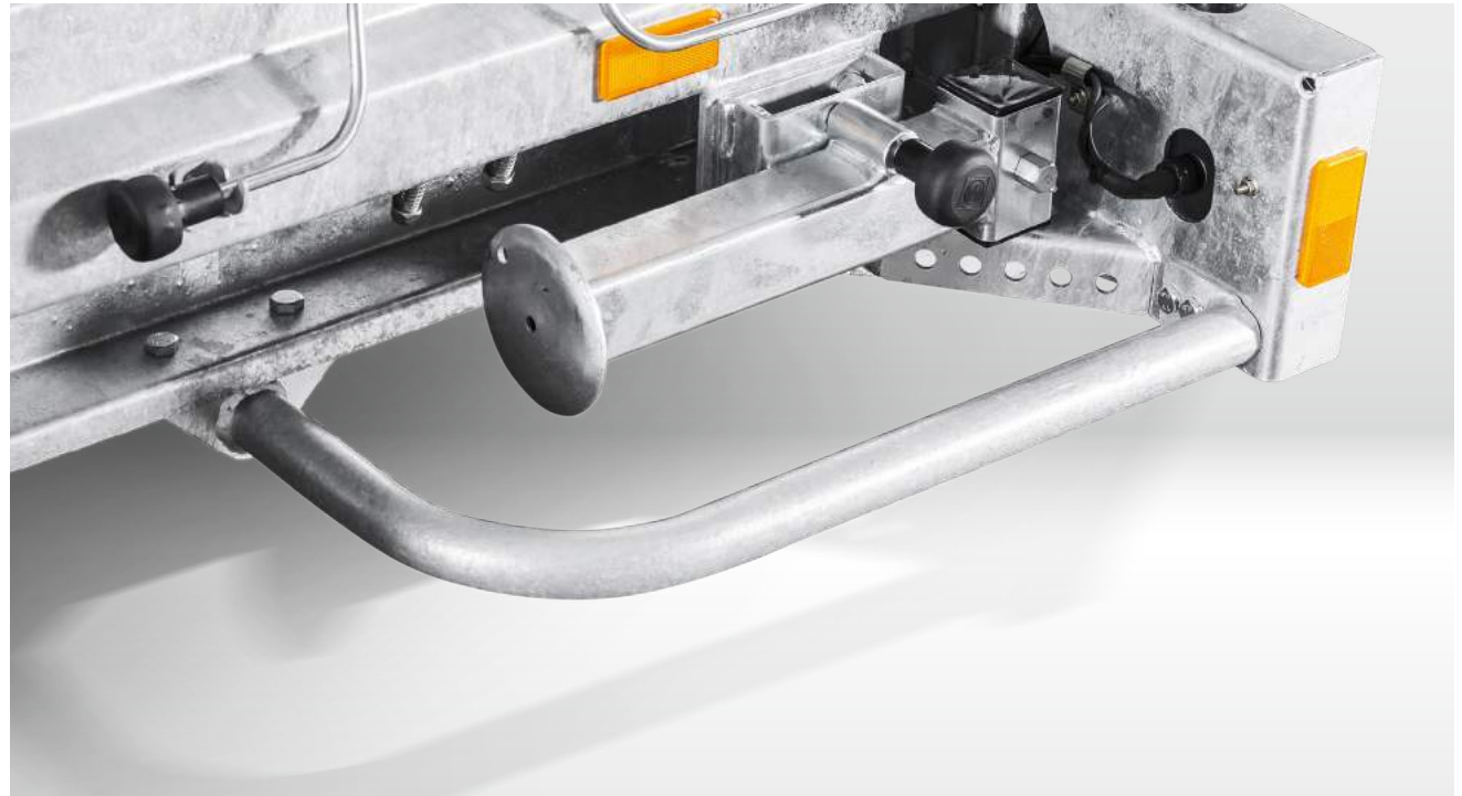
Schutzbügel Der Bügel schützt und stützt den Leuchtenkasten gegen seitliches Anfahren und Verformung (Abbildung zeigt Zubehör: Teleskopkurbelstütze).
