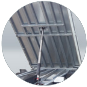
Robuste Stabilisierung der Ladefläche durch Kastenprofile
