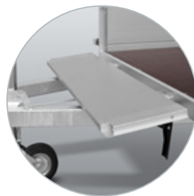
Vorderbordwand kann auf der Deichsel aufliegen
